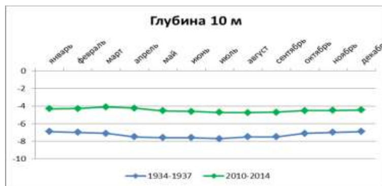
Рис. 2. Изначальная (1934-1937 гг.) и современная (2010-2014 гг.) термограммы многолетнемерзлых пород одного и того же ландшафта урбанизированной территории криолитозоны в слое годовых теплооборотов
