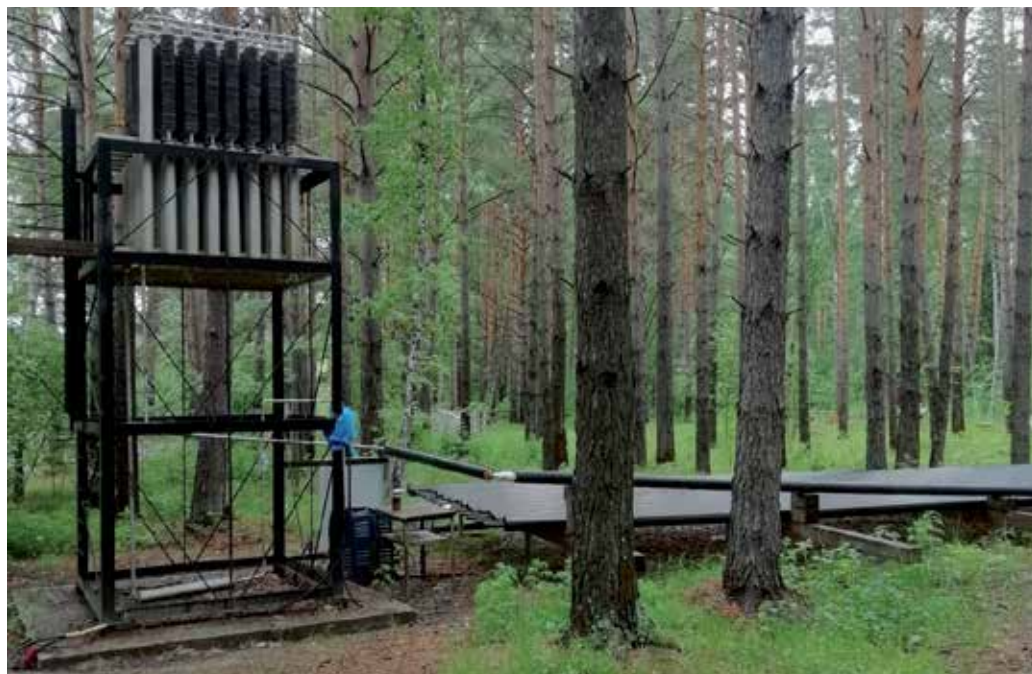
Рис. 2. Общий вид экспериментальной установки. На башне находится конденсатор. Справа расположена испарительная система
